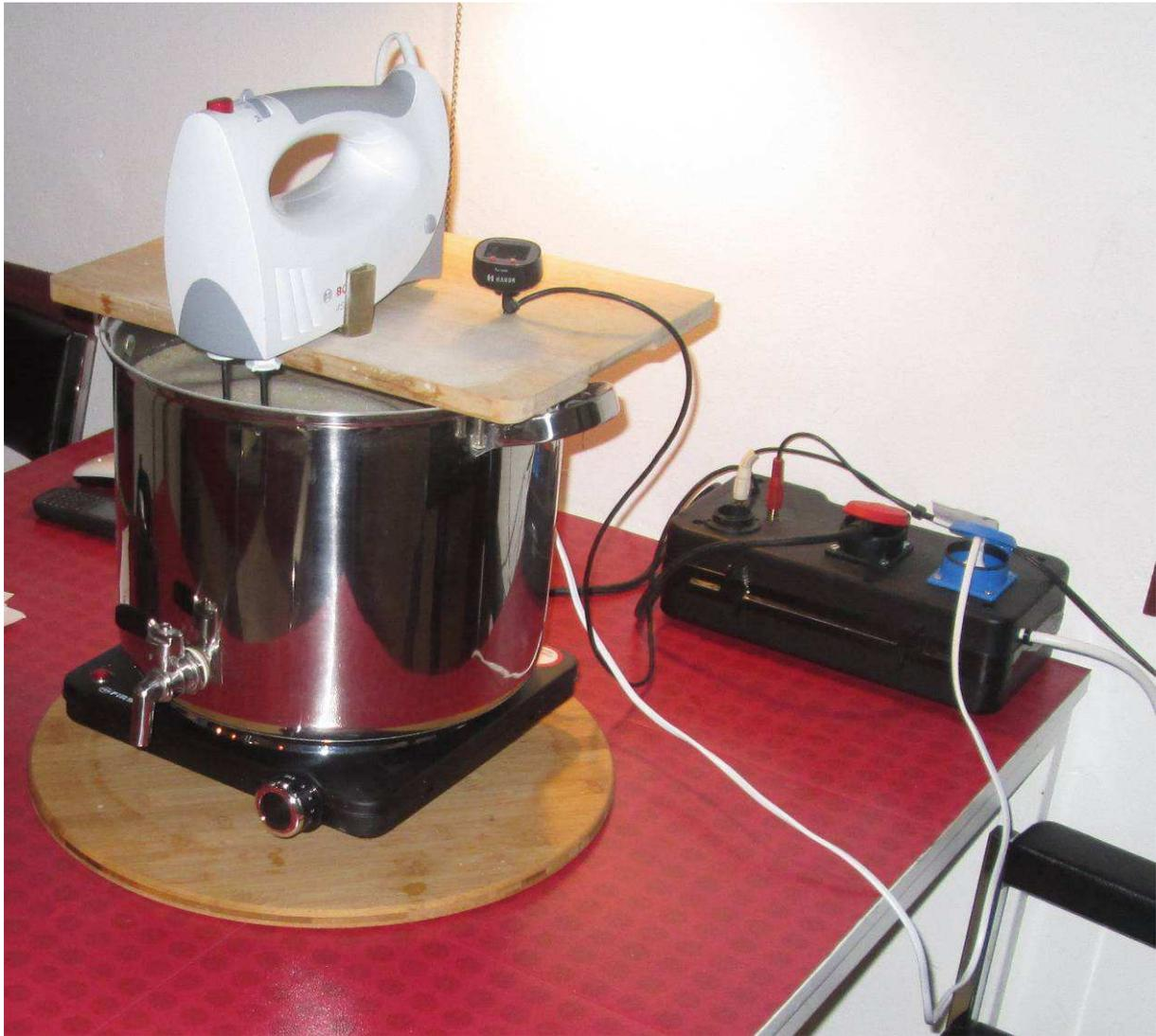
Die Kochplatte und der Temperatursensor sind hier über den schwarzen Kasten an meinem Rechner angeschlossen. Von dort erfolgt die Temperaturregelung mit einem selbst gebastelten Programm, das ich in VBA mit Excel erstellt habe.
