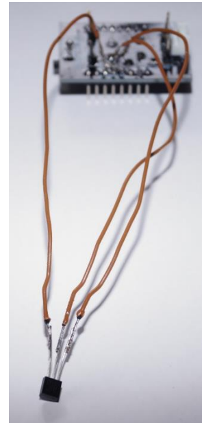
Abbildung 10b: Temperatursensor DS18B12 mit Litzen
