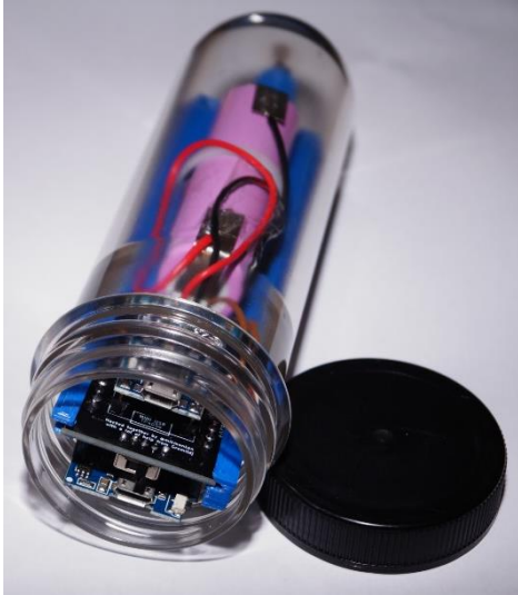
Abbildung 114: iSpindel mit Schlitten im PETling
