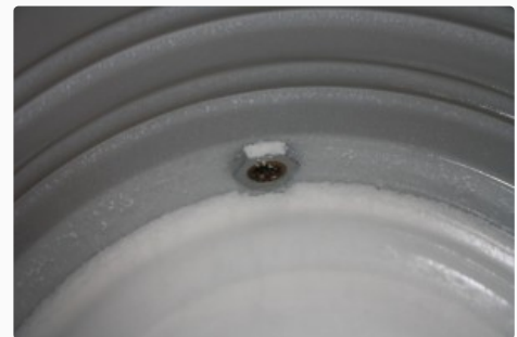
Beim Enthärten mit Kalkmilch fallen die unlöslichen Karbonate als kreibiges Sediment aus.
