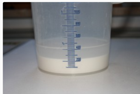
Dies aus 60 l Brauwasser ausgefallten Karbonate — eine beachtliche Menge!
